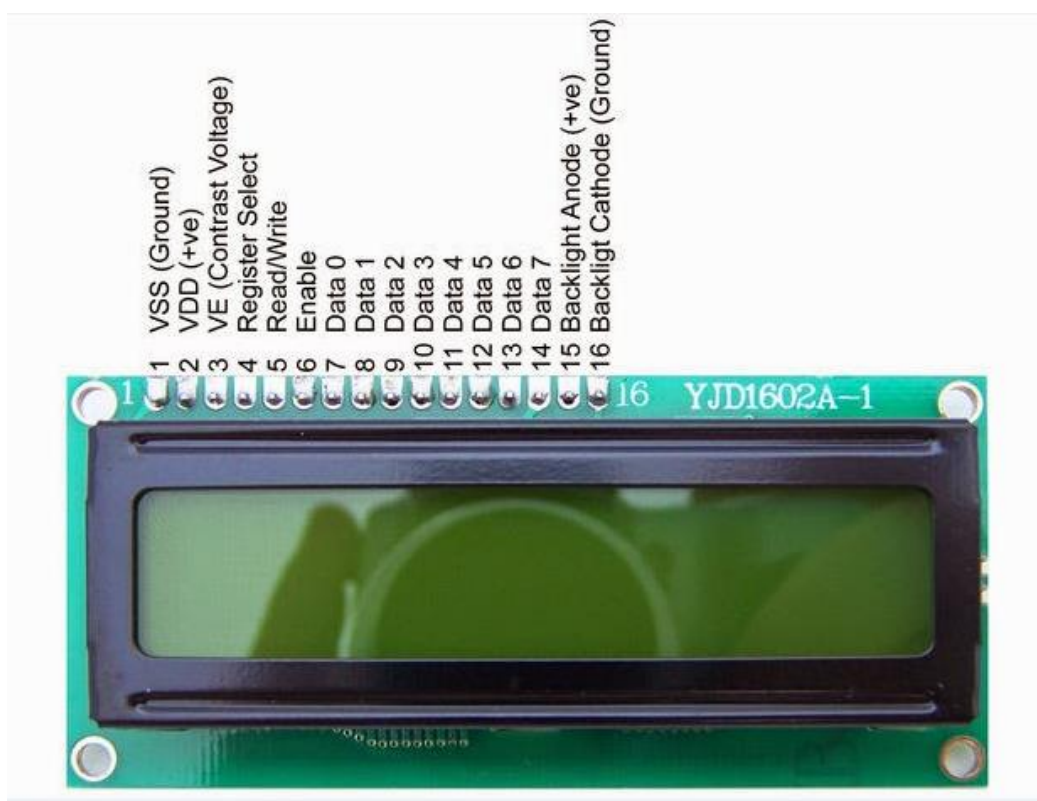
Сурет 2.9 – LCD дисплейінің шықпалары
